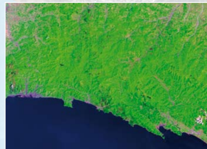
Fig. 2 - Immagine multispettrale rilevata dal sensore ETM+ del satellite Landsat-7 il 1 gennaio 2001 e visualizzata in falsi colori (RGB 431).
