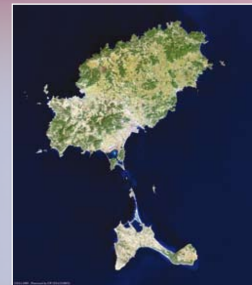
Fig. 5 - Immagine multispettrale delle isole di Ibiza e Formentera, rilevata dallo strumento ETM+ del satellite Landsat-7 il 10 agosto 2000 e visualizzata in falsi colori (RGB 741).
