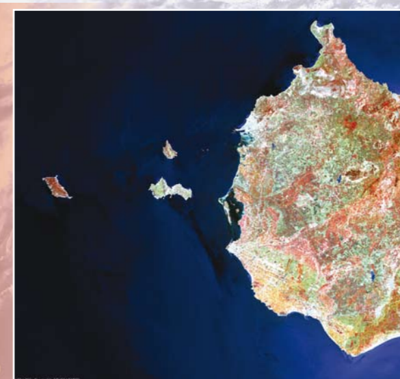
Fig. 6 - Immagine multispettrale della Sicilia occidentale rilevata il 22 giugno 2000 dallo strumento ETM+ del satellite Landsat-7 e visualizzata in falsi colori (RGB 431) (cortesia ESA/ESRIN).
