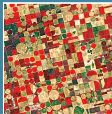
Fig. 4 - Immagine multispettrale del Kansas, rilevata dal TM di Landsat-5 il 4 marzo 2012 e visualizzata in falsi colori (RGB 4,3,2) (cortesia USGS/ESA).
