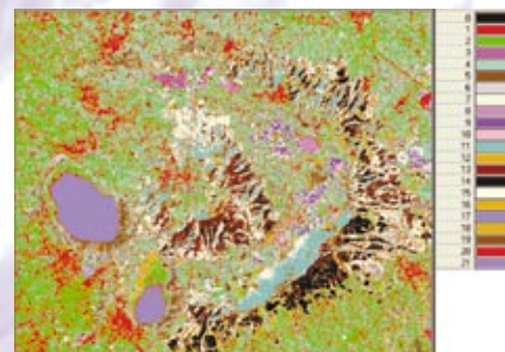
1. Classificazione dell'immagine multispettrale del Landsat-5 sulla zona dei Castelli Romani. Colori diversi sono assegnati alle varie classi individuate, le cui caratteristiche sono normalmente descritte in tabelle separate (cortesia E. Loret).
