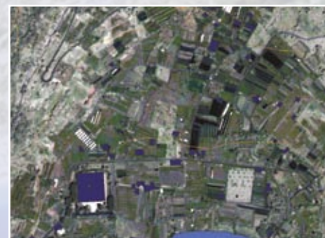
3. La sovrapposizione di un'immagine multispettrale Landsat-5, di una ad alta risoluzione geometrica SPOT-3 Pancromatico, e del Modello Digitale del Terreno ricavato dai dati del SAR imbarcato su ERS-1 dà un'immagine finale tridimensionale di ottima qualità in un Sistema Informativo Geografico (cortesia A. Argentieri).
