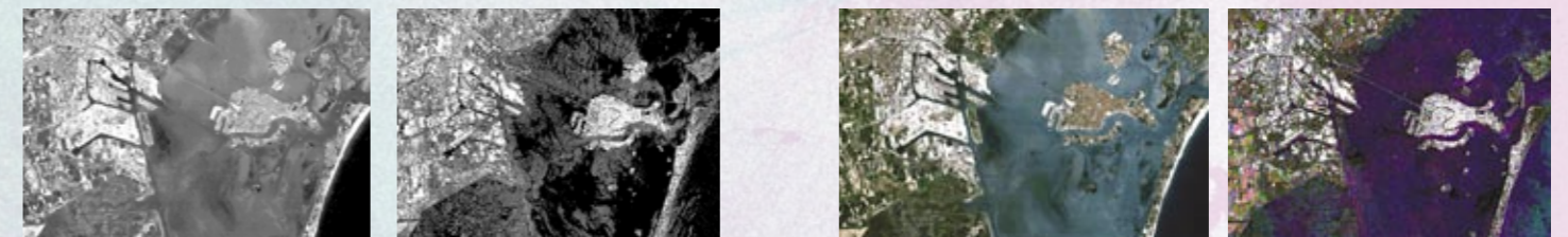
5. A confronto sulla città di Venezia, rispettivamente: un'immagine in Banda 1 di Landsat-5 TM, un'immagine ERS-1 SAR, un'immagine multispettrale di Landsat-5 TM, un'immagine multitemporale ERS-1 SAR.
