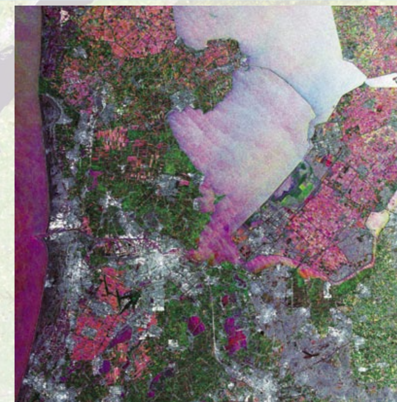
4. Immagine multitemporale dell'ASAR di Envisat, generata dai dati acquisiti il 19/11/03 (visualizzati nel Rosso), il 19/03/03 (Verde) e il 06/08/03 (Blu).
