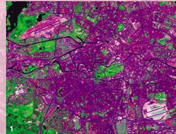
1. Immagine multispettrale del satellite Landsat-5 acquisita il 6 luglio 2006 e visualizzata in falsi colori (RGB 742).
